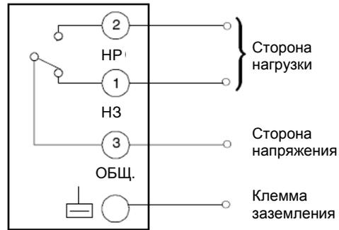
Рис. 2. Схема соединений реле С6097А
