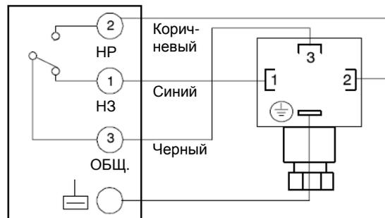
Рис. 3. Схема соединений реле С6097А с разъемом DIN
